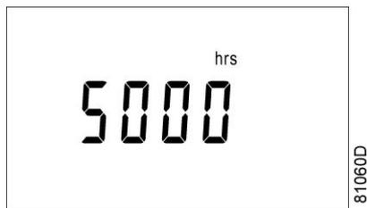
В приведенном примере на экране отображается используемая единица измерения (hrs)(часы) и значение (5000): модуль регулятора работал в течение 5000 часов.
