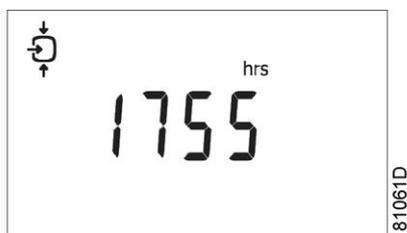
В окне показана используемая единица измерения <hrs>(час) (или <x1000 hrs> (кол-во часов x 1000)) - и само значение <1755>: количество часов наработки блока составляет 1755 часов.
