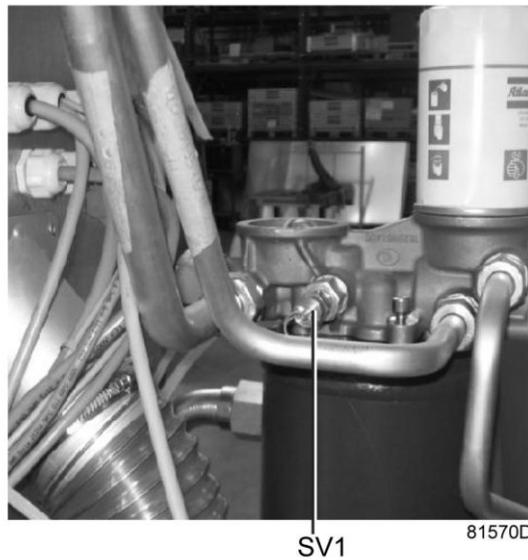
*Предохранительный клапан резервуара маслоотделителя*
