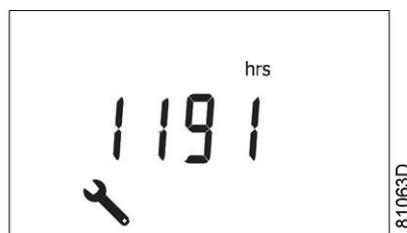
На экране показаны текущие единицы измерения <hrs> (часы) (или <x1000 hrs> (x1000 часов)) и значение <1191>. В приведенном примере компрессор отработал 1191 часов со времени последнего технического обслуживания.
